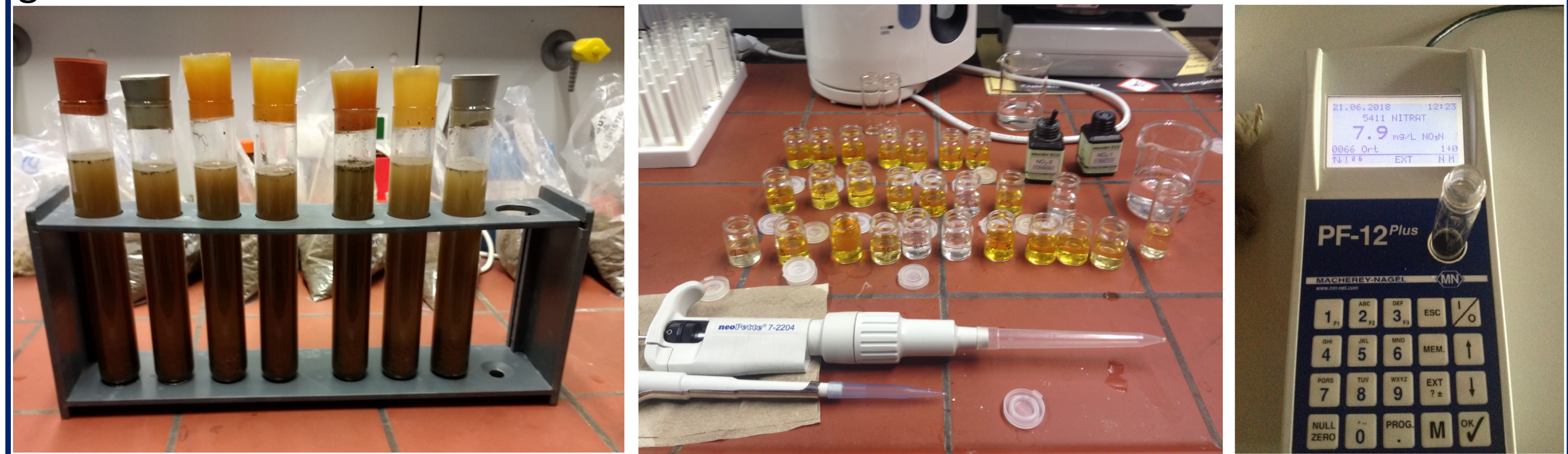
Abbildung 3: Bestimmung des extrahierbaren Nitrats (a) CaCl 2 – Ansatz mit Boden; (b) Nitratbestimmung mit Nitrat-Testlösung; (c) Fotometrische Messung
